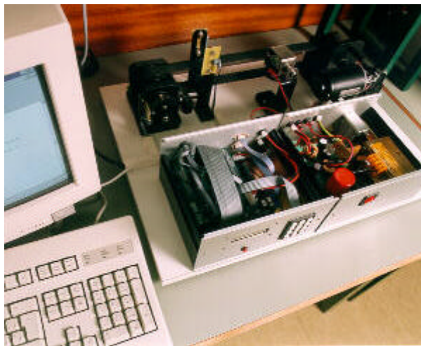
Figura 1: Detall de la maqueta de cinta transportadora amb l'electrònica al descobert
